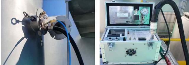
[그림 6] VOC 측정센서와 측정 장비
