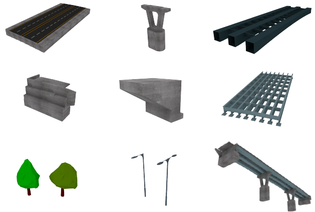
[그림 4] 교량 3D 모델링 라이브러리 구축 결과(일부)
