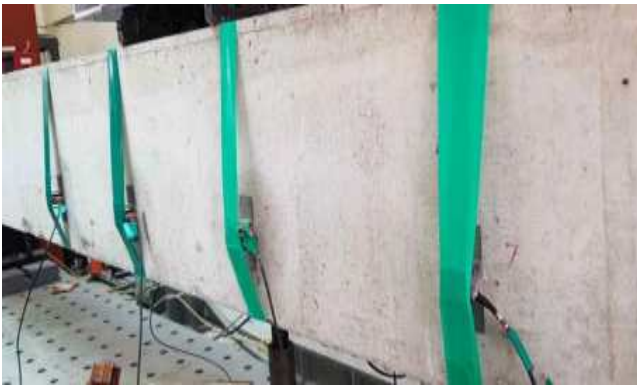
[그림 3] 위험물 저장탱크 기둥의 철근콘크리트 음향방출기술 시험
