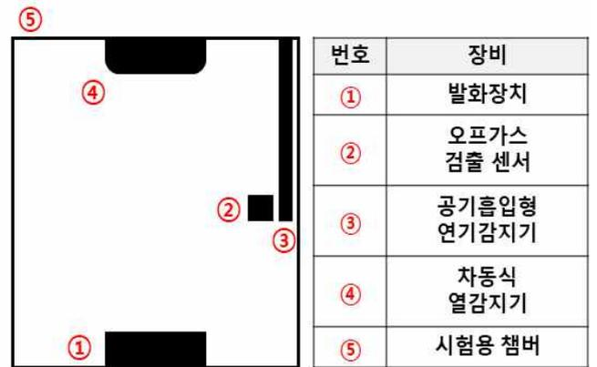
[그림 3] ESS 화재 모의시험장치 구성도
