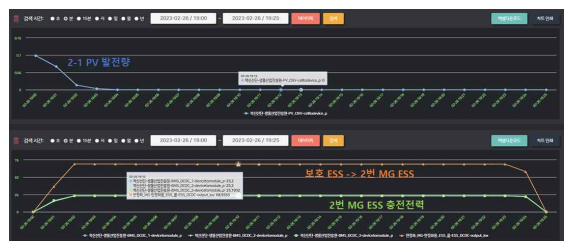
[그림 6] 보호 ESS -> 2-1 ESS 충전
