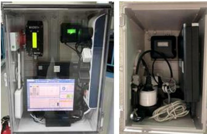
[그림 2] 환경재난 모니터링 시스템 (좌: 미소지진동 센서, 우: 변이 감지 센서)
