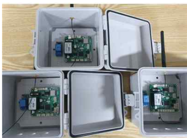
[그림 3] 지게차 표시 장치 PCB 제작 모습
