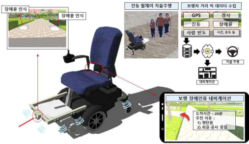
[그림 1] 장애인 보조기구에 최적화된 안전 시스템 개요도
