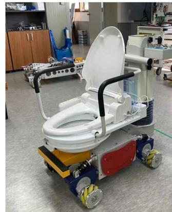
[그림 5] 배변 리프트 시스템 완성 모습
