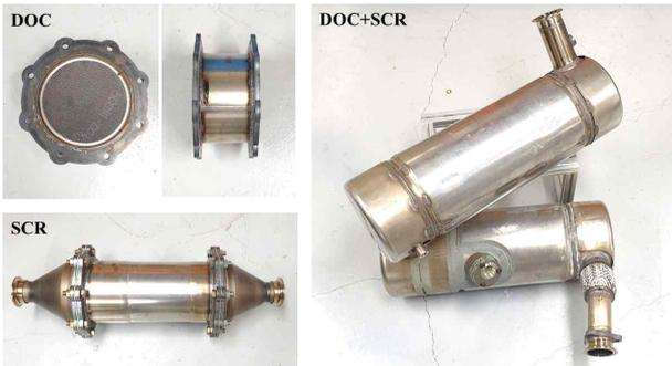
[그림 3] 실험용 후처리장치 DOC와 SCR
