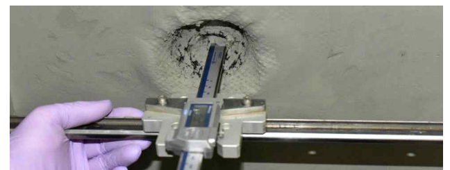
[그림 5] Method of measurement for P-BFS
