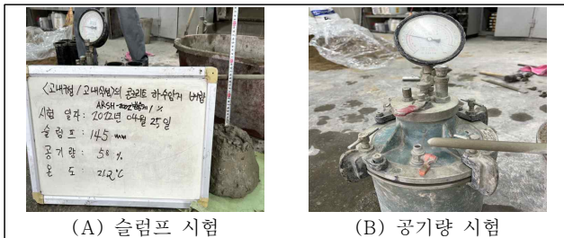
[그림 2] 슬럼프 및 공기량 시험
