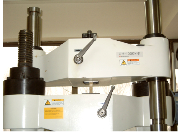
[그림 4] SHIMADZU사의 만능 시험기 (UH-1000kNI)
