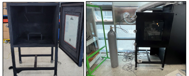
[그림 7] 시험용 챔버와 질소 분사 장치
