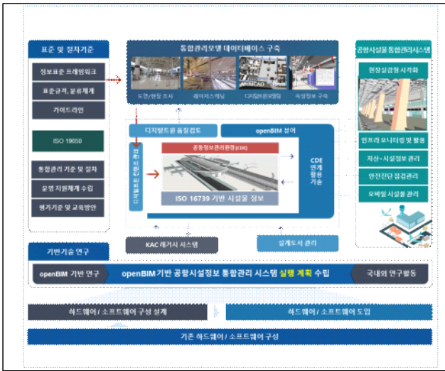
[그림 1] KAC-BIM 시스템 개념도
