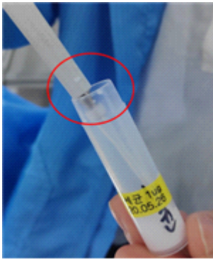
[그림 1] 시료 주입 시 피펫의 몸체에 시료가 묻는 경우(오염)
