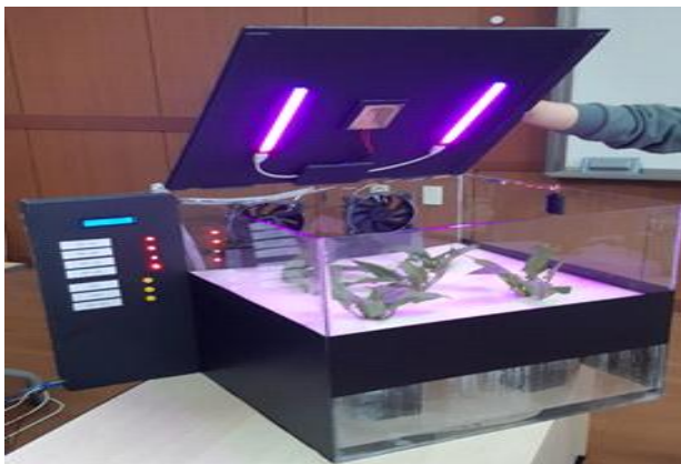
[그림 8] 가정용 스마트 팜의 운영 시험
