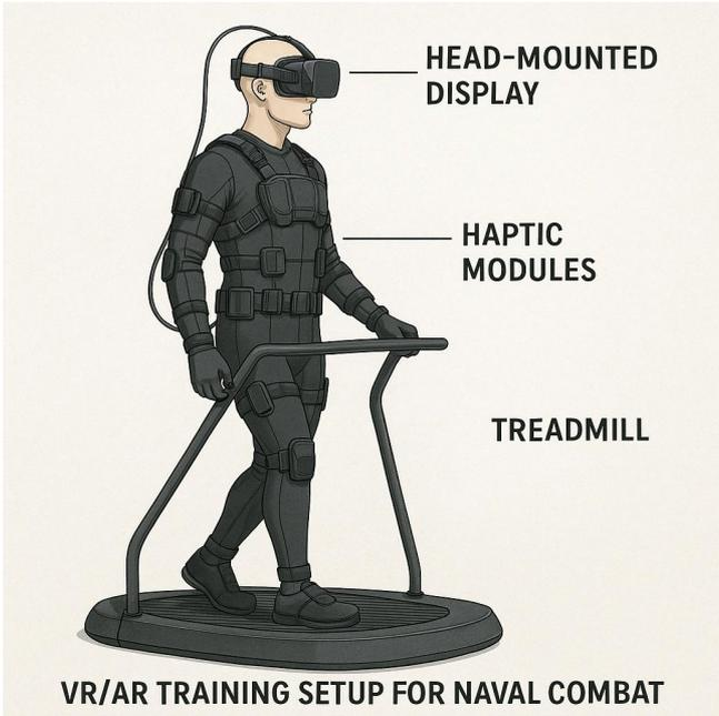
[그림 1] 착용형 HMD 셋업과 트레드밀·햅틱슈트 결합 예시
