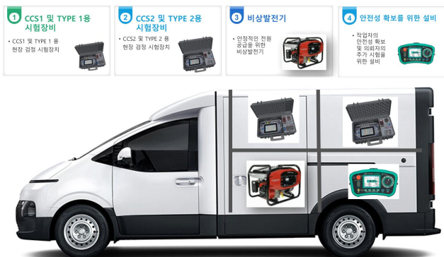
[그림 6] 이동형 전기자동차 충전기 시험·검정 시스템 구성도(안)
