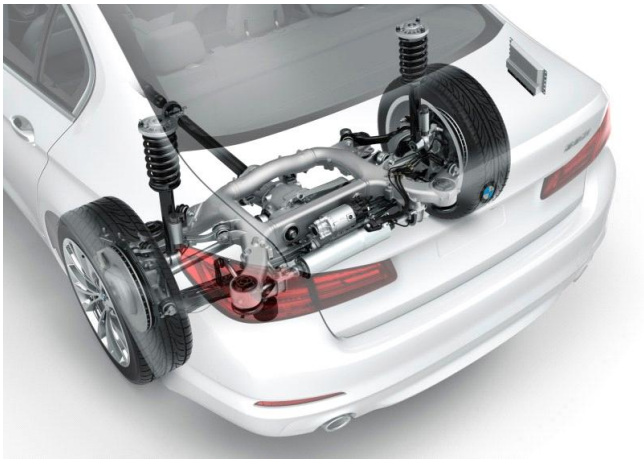
[그림 2] 후륜조향 장치의 차량 장착 이미지 [11]
