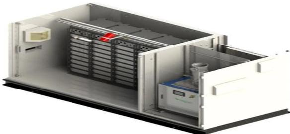
[그림 1] 해석을 위한 ESS 3D 모델링
