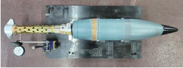
[그림 2] 강선형 박격포탄 정렬 측정
