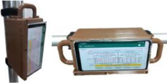
[그림 1] 내압 및 잔압이 있는 파이프 이상 여부 진단 시스템 설치 모습
