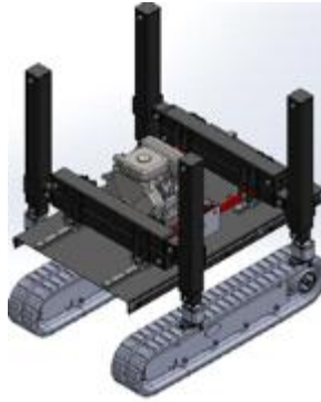
[그림 1] 지능형 비닐하우스 파이프 구멍 천공 장치 3D 모델링
