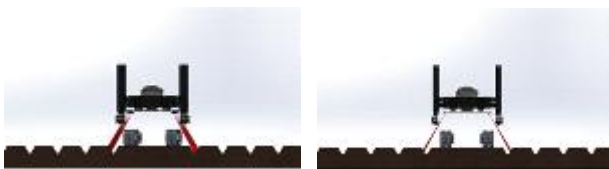
(a) 천공 위치 및 방향 정렬 전 (b) 천공 위치 및 방향 정렬 후 그림 2. 레이저 센서를 이용한 주행 방향 자세 보정
