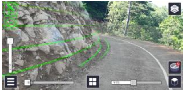
[그림 3] LBARsystem 시스템에 의한 도로의 선형 추적
