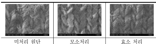
< 필링방지처리 후 표면변화(SEM) >
