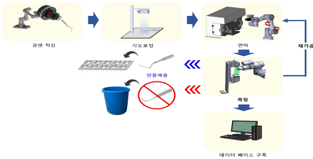
[그림 7] 위치 및 측정용 머신비전 공정 순서
