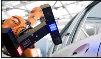
[그림 6] 측정용 머신비전 모듈 구성 예시
